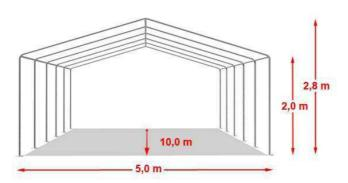
Surface : 5mx10m = 50 m2 Hauteur côté : 2m Hauteur faitage: 2.8m Dimension porte : Largeur 3.8m Hauteur: x 2m
